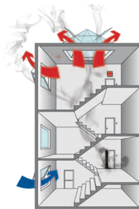
Рисунок № 2 Здание с оконной системой дымоудаления mcr-OSO
